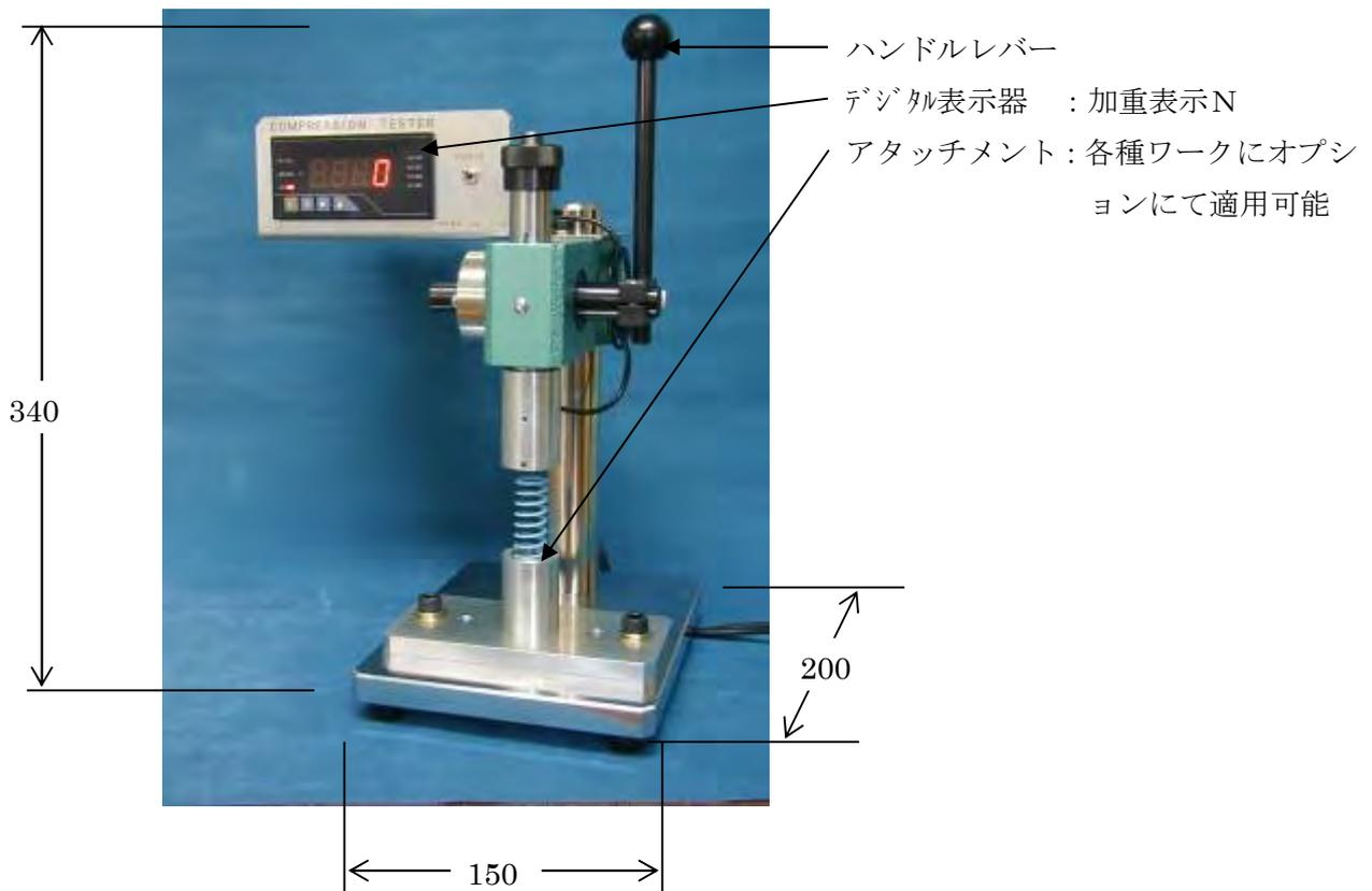
スプリング荷重、カシメ、溶接の強度試験最適！！
